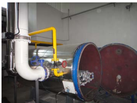
图4 真空舱及舱内中空纤维膜机载制氮装置
